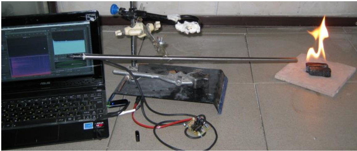
Рис. 4.3. Лабораторна установка з експериментального дослідження властивостей процесу акустичного випромінювання в осередку горіння
