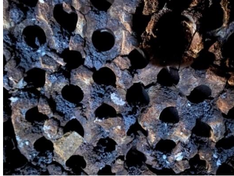
Рис. 1. Обгоряння керамічних насадок
