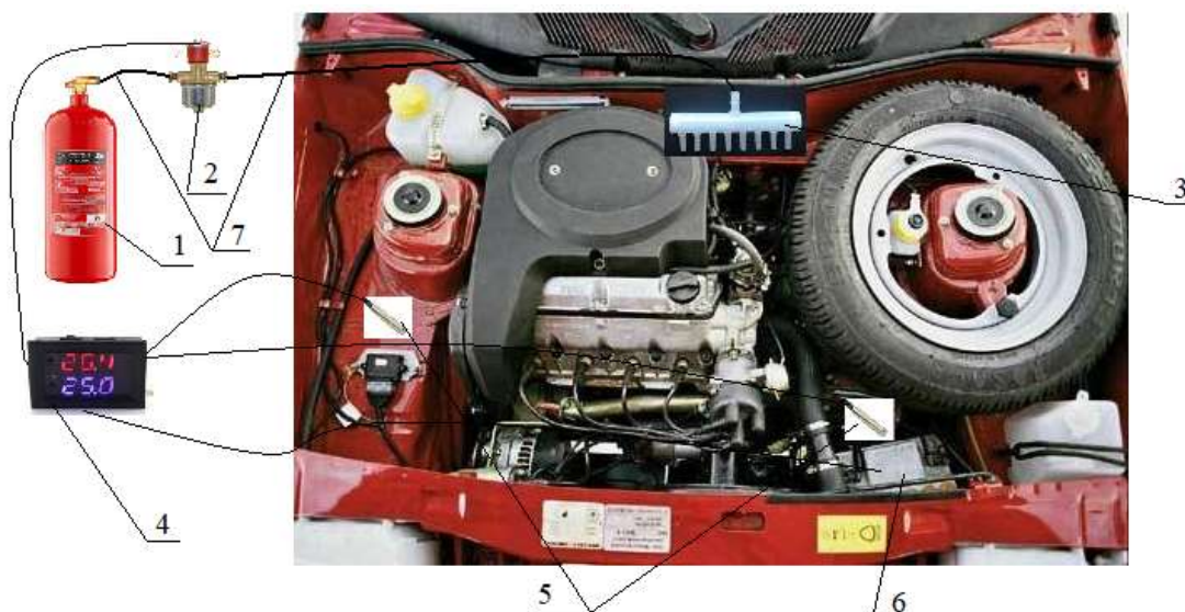
Рис. 1. Схема установки для автоматичного пожежогасіння на легковому автотранспорті.
