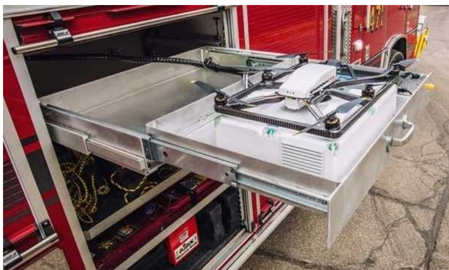
Рис. 1 – Вигляд БПЛА Pierce Fotokite в транспортному положенні
