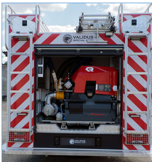
Рис. 2 – Пожежна мотопомпа від компанії Rosenbauer на висувній платформі
