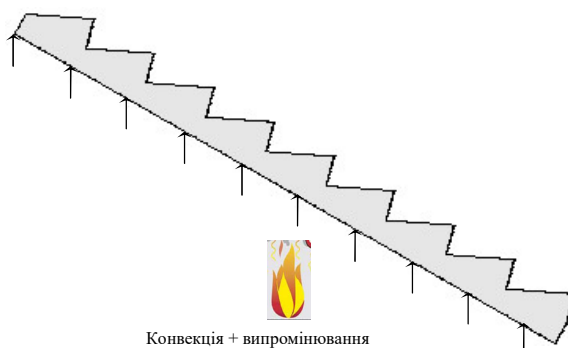
Рис. 2. Схема здійснення теплового впливу на залізобетонний марш.
