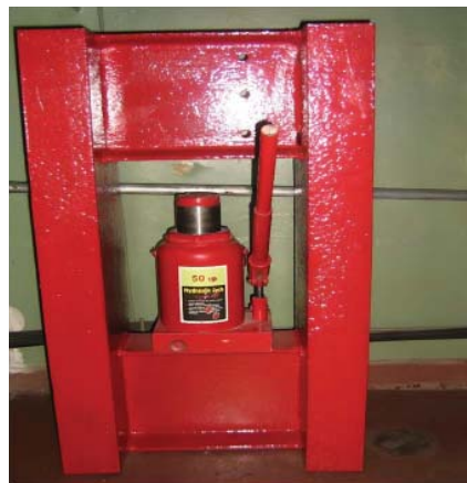
Fig. 3. Zinc target molding press
