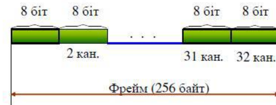
Рисунок 48 – Формат лінійного сигналу ІКМ-30/32
