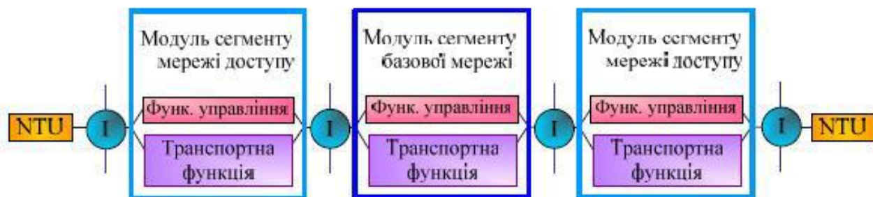
Рисунок 21 – Зразок утворення транспортної підсистеми на рівні функціональної моделі I (еталонна точка телекомунікаційної мережі); NTU мережеве закінчення I – інтерфейс (еталонна точка телекомунікаційної мережі); NTU – мережеве закінчення.
