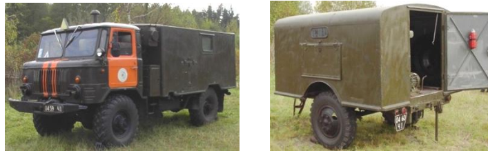
Рис. 3. Військова фільтрувальна станція ВФС-2,5
