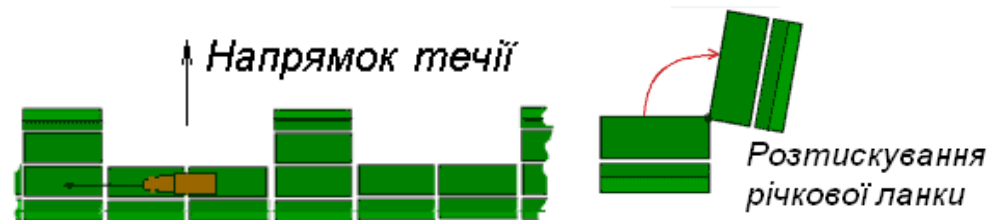
Рис. 15. 20-тонна схема ділянки наплавного моста
