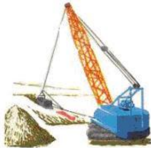
Рис. 5. Робота одноківшового екскаватора з драглайном
