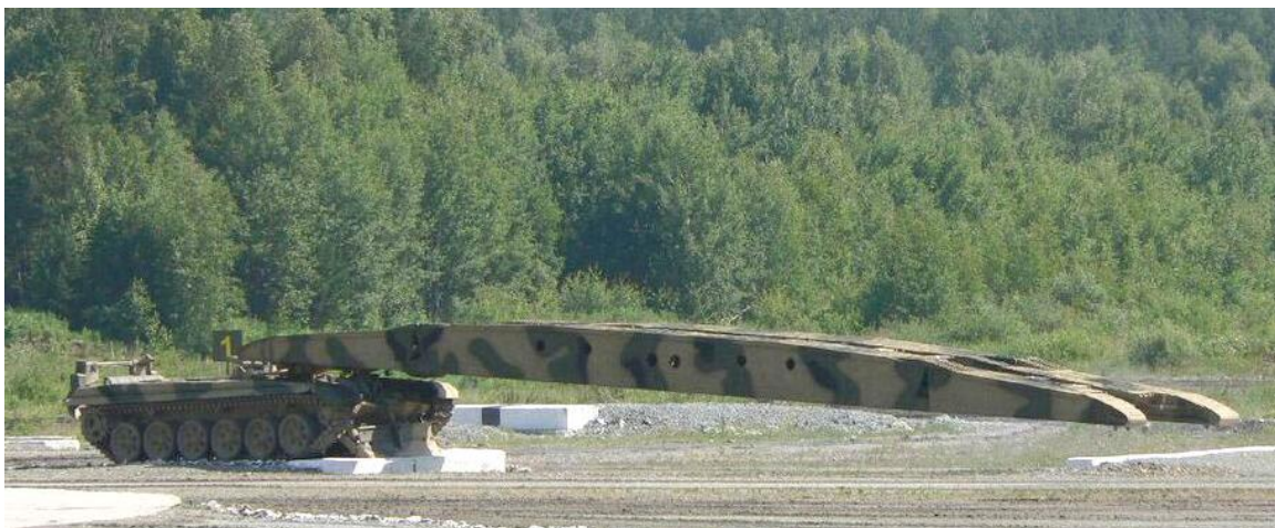
Рис. 10. МТУ-72 у момент встановлення мосту
