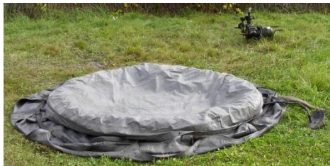
Рис. 4. Резервуар РДВ-5000 для збору чистої води підготовлений для прийому чистої води
