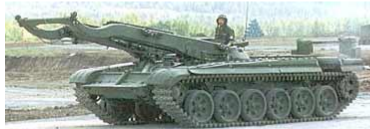
Рис. 8. Мостукладчик без моста
