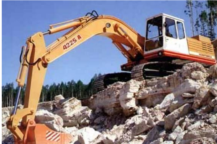
Рис. 9. EO-4225A - Екскатор-призначений для розробки ґрунтів 1-4 категорії та попередньо розпушених скельних і мерзлих ґрунтів, 5-6 категорій, а також для навантаження ґрунту і сипучих матеріалів.
