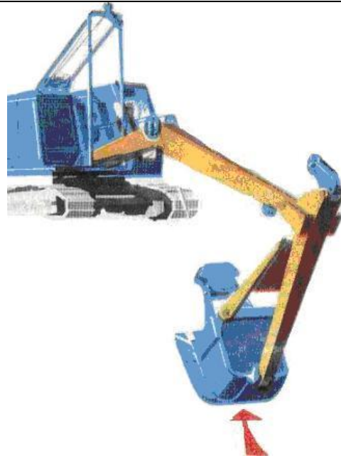
Рис. 4. Робота однокішшевого екскаватора зі зворотною лопатою
