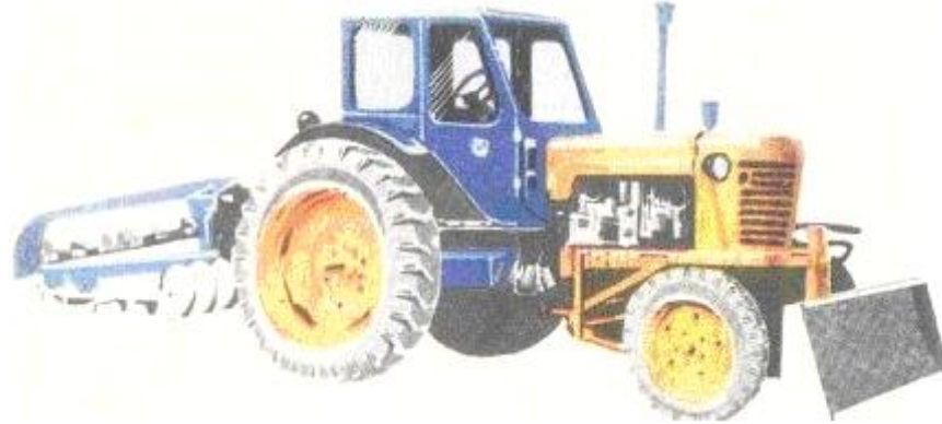
Рис. 2. Багатоковшевий ланцюговий екскаватор ЕТЦ-161 на колісному тракторі
