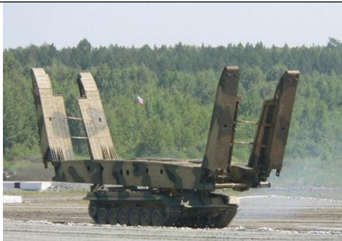
Рис. 9. МТУ-72 у момент розкладки кінцевих частин моста
