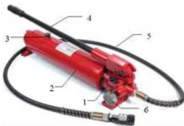
Рисунок 6.31 Будова ручного гідравлічного насоса
