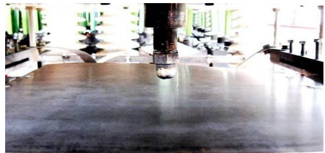
Рис. 5. Внешний вид ИО стальной кровли, закрепленного в ДЭС с ЭВП на рабочем столе генератора типа УИТОМ-1, до прямого воздействия на него от высоковольтных генераторов ГИТ-А и ГИТ-С импульсной A- и длительной C- компонент тока искусственной молнии ( h_a=27 мм; l_e=50 мм)
