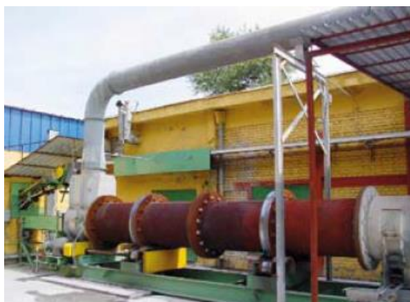
Рис.1. Барабанна піч, що обертається, для спалювання вибухонебезпечних предметів
