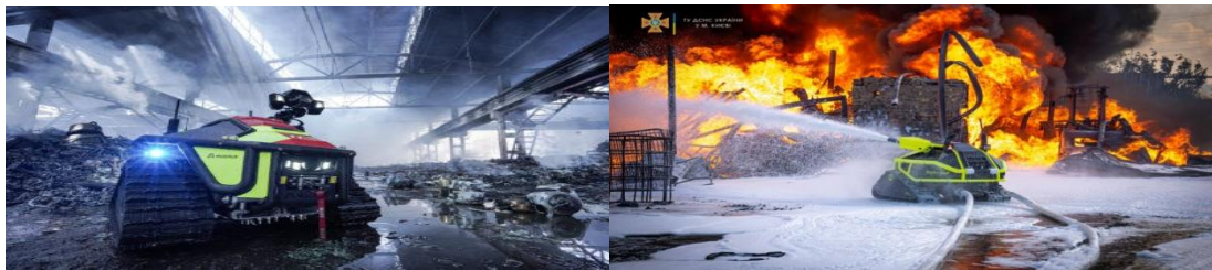
Рис. 1. Роботизовані системи пожежогасіння «Wolf R1» та «Alpha Wolf»
