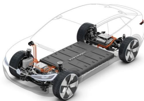
Рис. 1. – Схема розташування акумуляторних батарей в електромобілі
