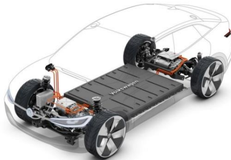
Рис. 1. – Схема розташування акумуляторних батарей в електромобілі
