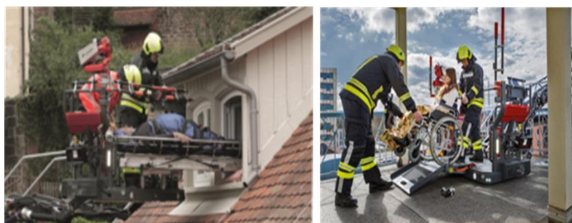
Рисунок 2 – Вигляд люльки, якою обладнані автодрабини від компанії «Metz»
