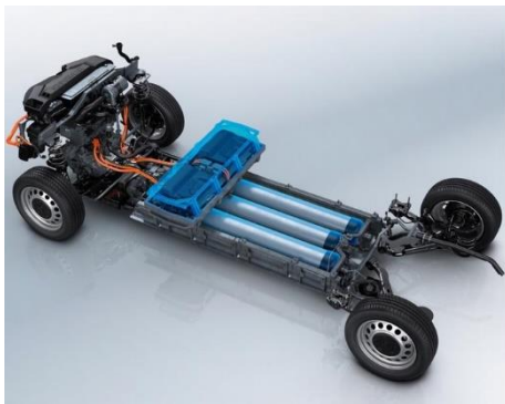
Рисунок 2 – Платформа з паливними елементами (а). Заправлення автомобіля воднем (б) [2]
