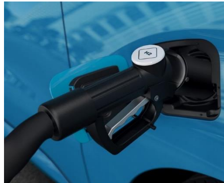
Рисунок 2 – Платформа з паливними елементами (а). Заправлення автомобіля воднем (б) [2]
