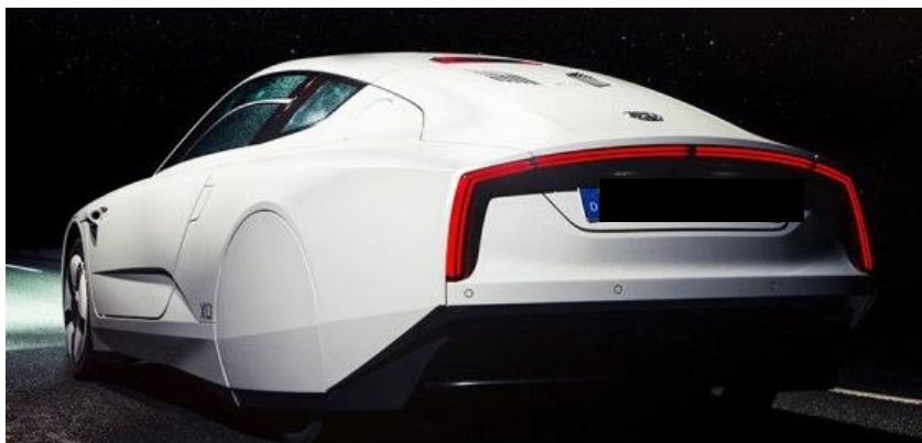
Рисунок 2 – Форма кузова сучасної моделі Volkswagen XL1 ( C_x 0,19)
