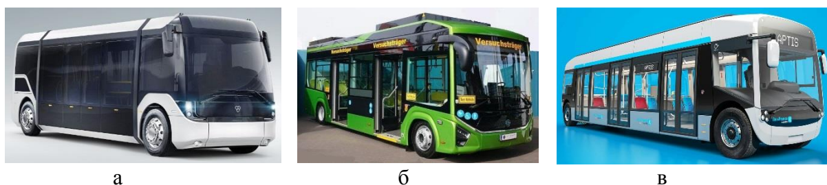
Рисунок 2 – Міські низькопідлогові електробуси з подвійними пасажирськими дверима у межах колісної бази моделей: а) "TAM Europe Vero"; б) "Steyr eCITY 9"; в) "Alstom Aptis"
