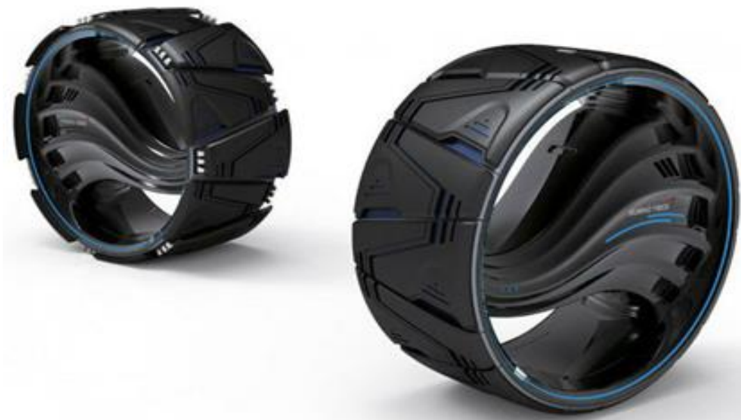
Рисунок 1 – Зовнішній вигляд шин, що змінюють структуру протектора оболонки
