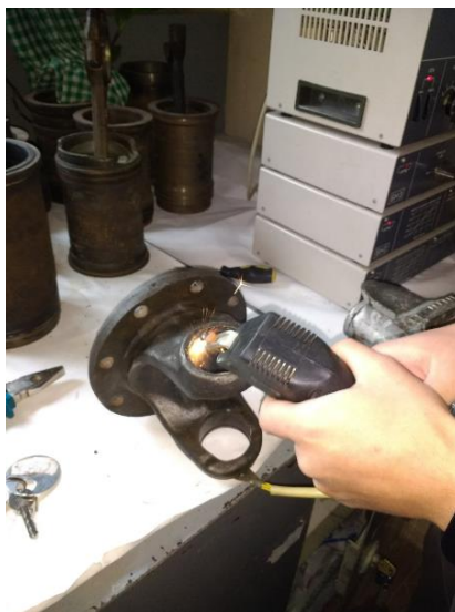
Рисунок 1 – Реставрація отвору вилки з застосуванням ЕІЛ
