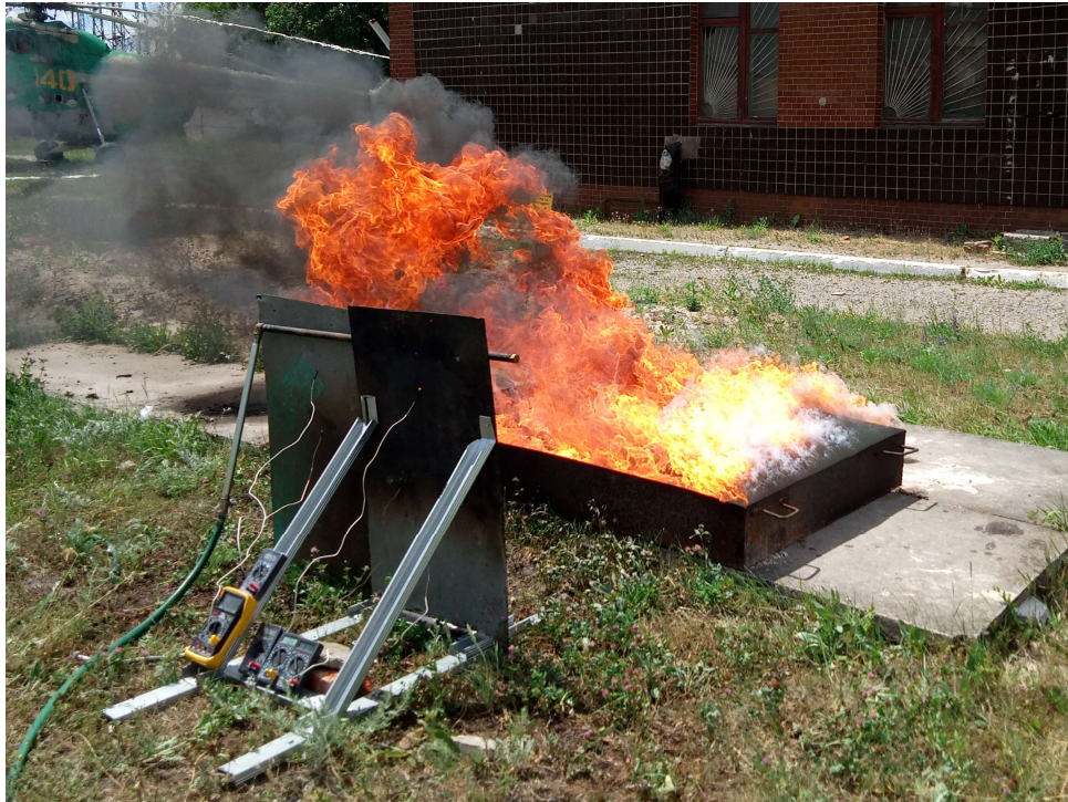
Рис. 3.20. Експериментальне визначення теплового впливу пожежі горючої рідини на модель стінки резервуара
