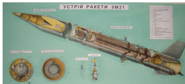
Рис. 1. Склад ТР 9M21Ф: БЧ 9Н18Ф і РЧ 9M21
