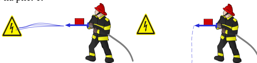
Рис. 1. Принцип роботи автоматичного пристрою електробезпеки рятувальника при подачі компактного струменя
