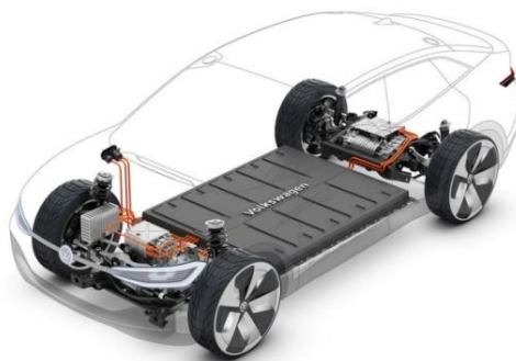
Рис. 1. – Схема розташування акумуляторних батарей в електромобілі
