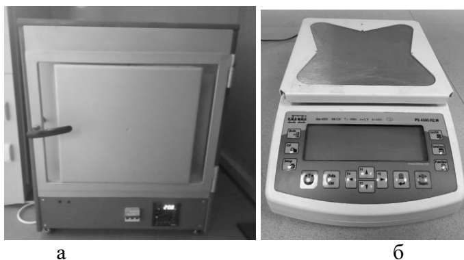
Рис. 1. Обладнання, що використовували для визначення лінійного коефіцієнта спучення K_L та втрати маси зразків \Delta m : а – муфельна піч СНО30/1100И4ПР; б – ваги REDWAG PS 4500.R2.M
