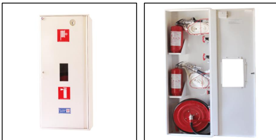
Рис. 15.2. Пожежний кран-комплект діаметром 50 мм з напівжорстким рукавом діаметром не менше 25 мм та двома вогнегасниками
