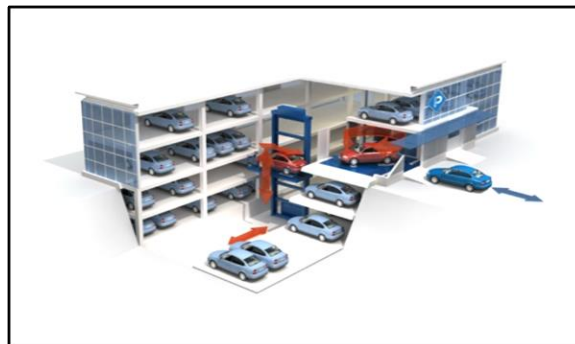
Рис. 18.8. Механізований гараж наземно-підземний
