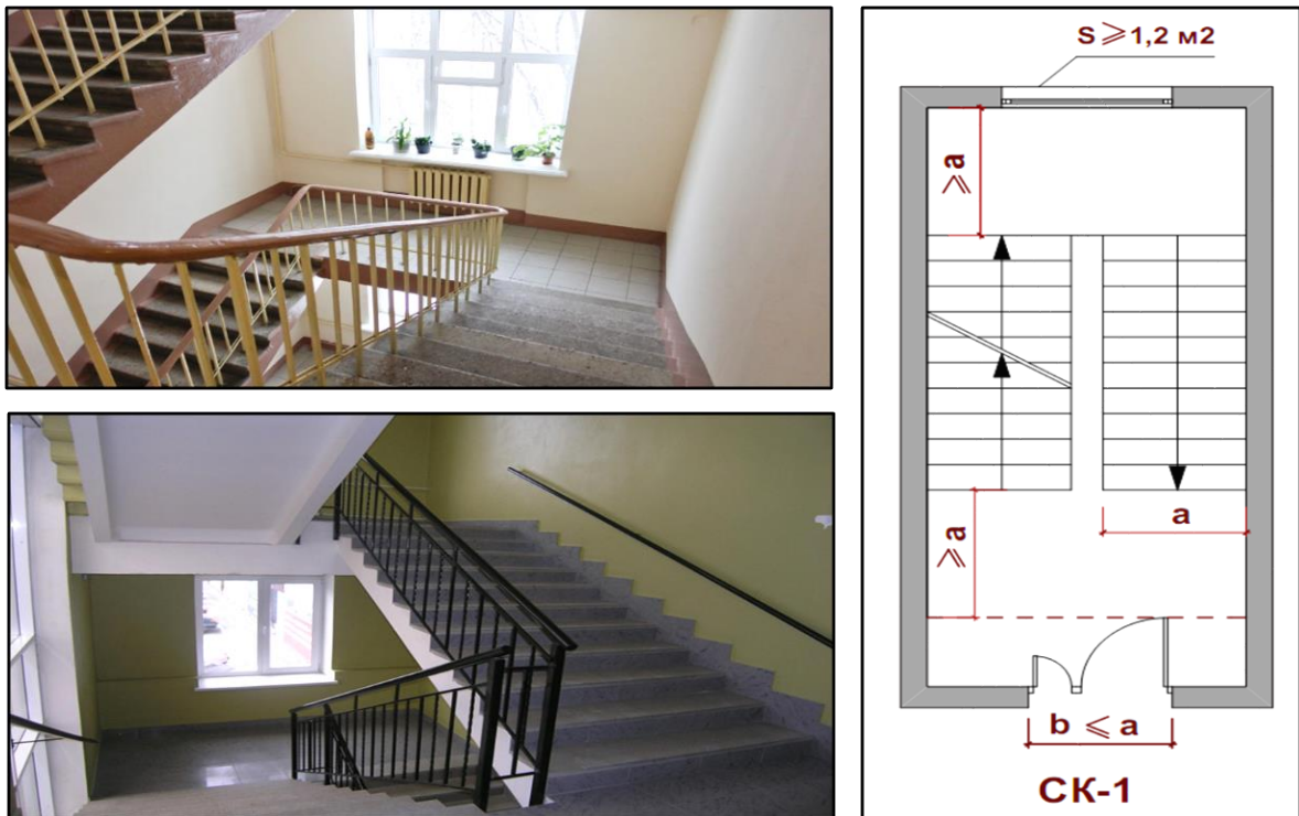
Рис. 3.2. Зображення звичайної сходової клітки типу СК1
