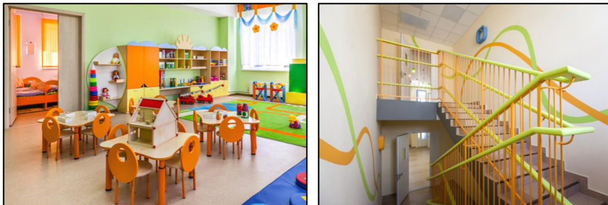
Рис. 16.4. Внутрішнє опорядження (облицювання) стін та стелі дитячих (групових і житлових) осередків та шляхів евакуації виконані з негорючих матеріалів
