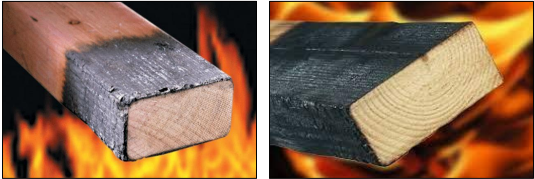
Рис. 7.2. Зразки деревини з вогнезахистом після температурного впливу
