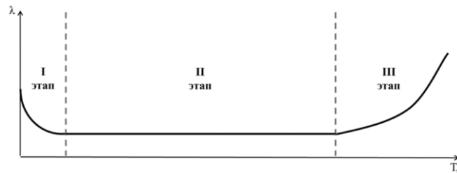
Рис. 1. Залежність інтенсивності відмов від терміну служби.
