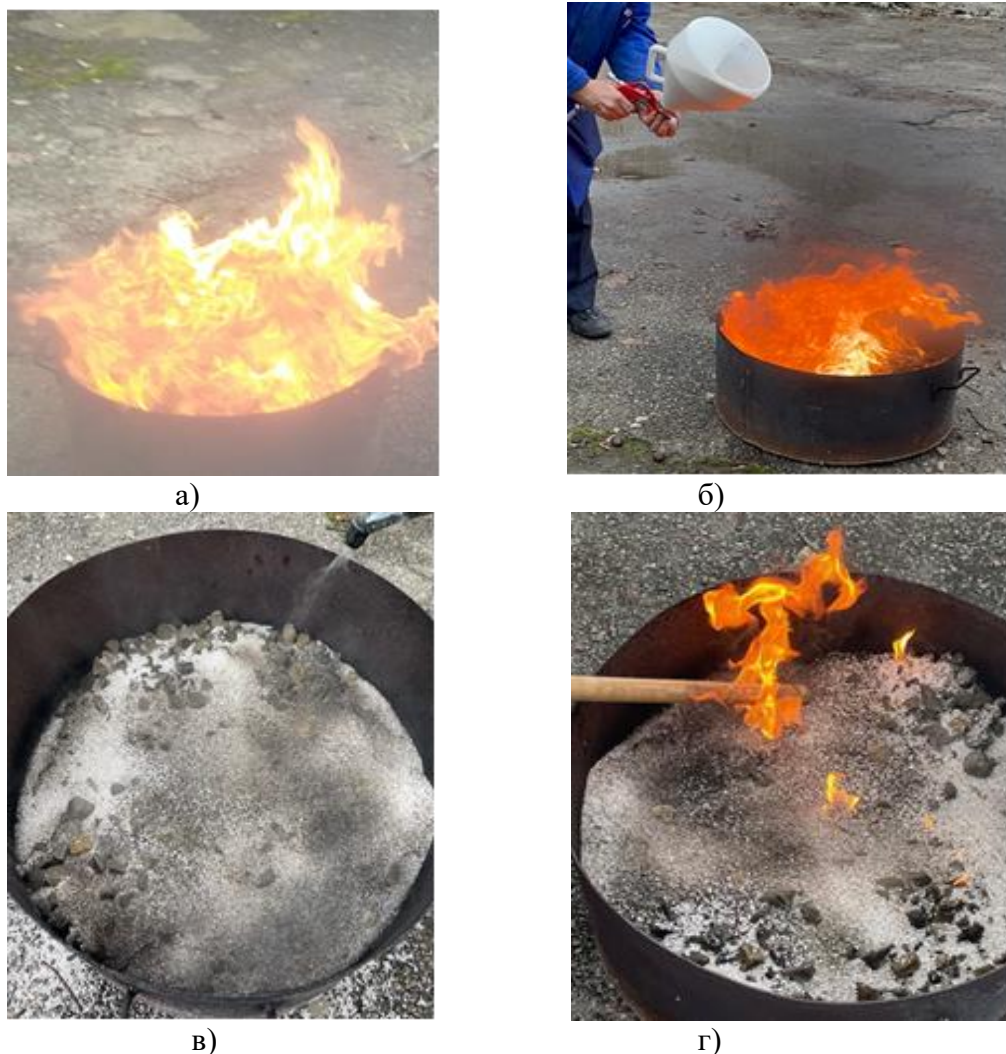
Рис. 1. Етапи гасіння модельного вогнища пожежі «8В»: а) зменшення висоти полум'я під час подавання ПС; б) зменшення висоти полум'я під час подавання ПС; в) припинення горіння після подавання води; г) дослід на повторне займання.
