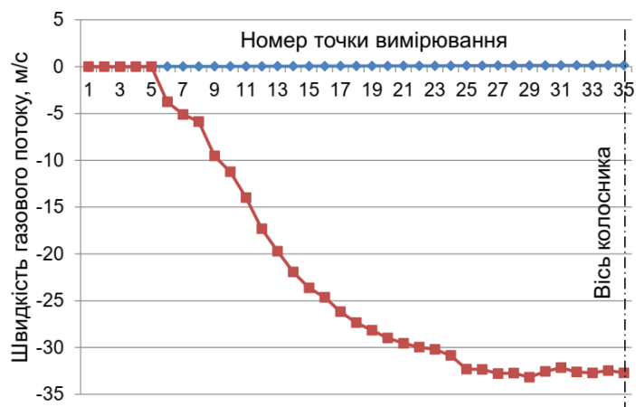
Рисунок 1 – Встановлена швидкість газового потоку, що виходить із шару шихти, що спікається, уздовж колосника агрегаційної машини типової конструкції АКМ-75
