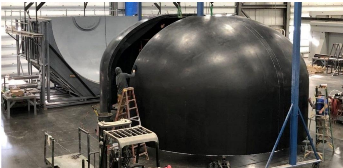
Рисунок 8 – Процес створення паливного баку компанії Rocket Lab
