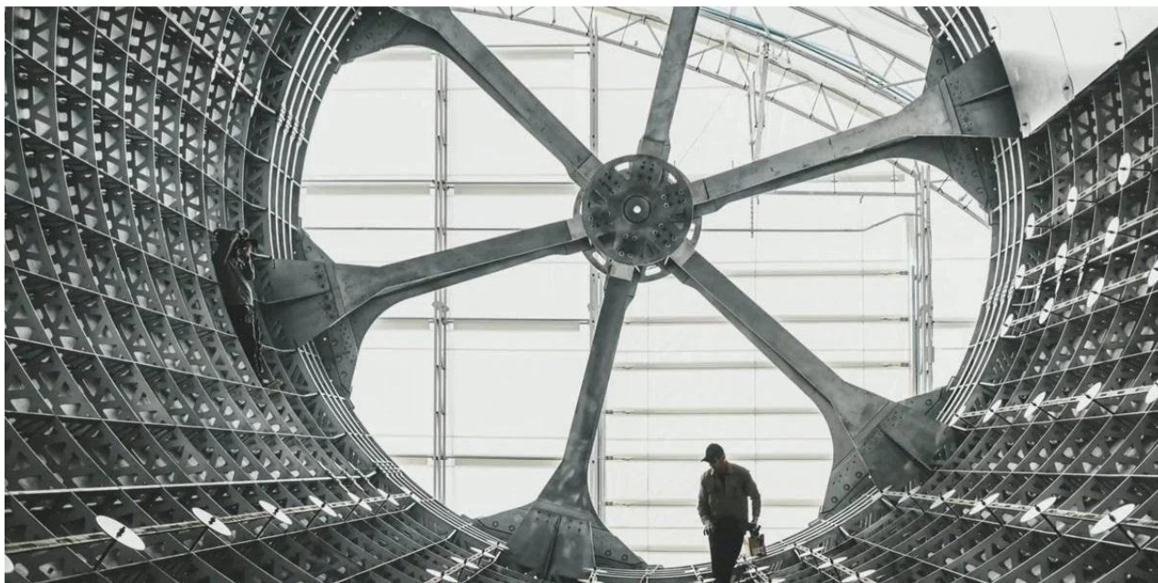
Рисунок 6 – Конструкція технологічної оснастки для виготовлення корпусу паливного баку із вуглепластику.
