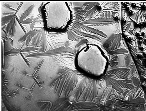
Рисунок 1 – Мікроструктура сталі типу P6M5 після тривалого відпалу та теплового вакуумного травлення, x1000
