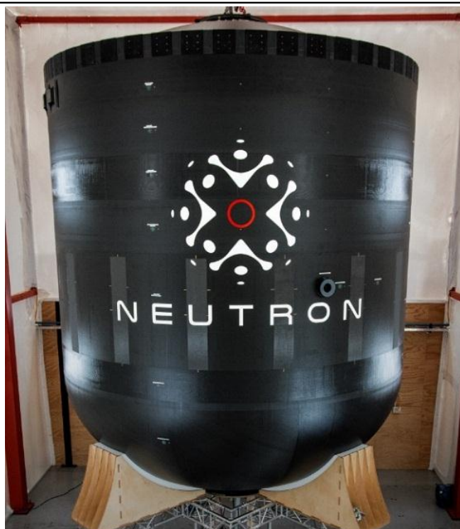
Рисунок 7 – Вуглепластиковий паливний відсік ракети Neutron
