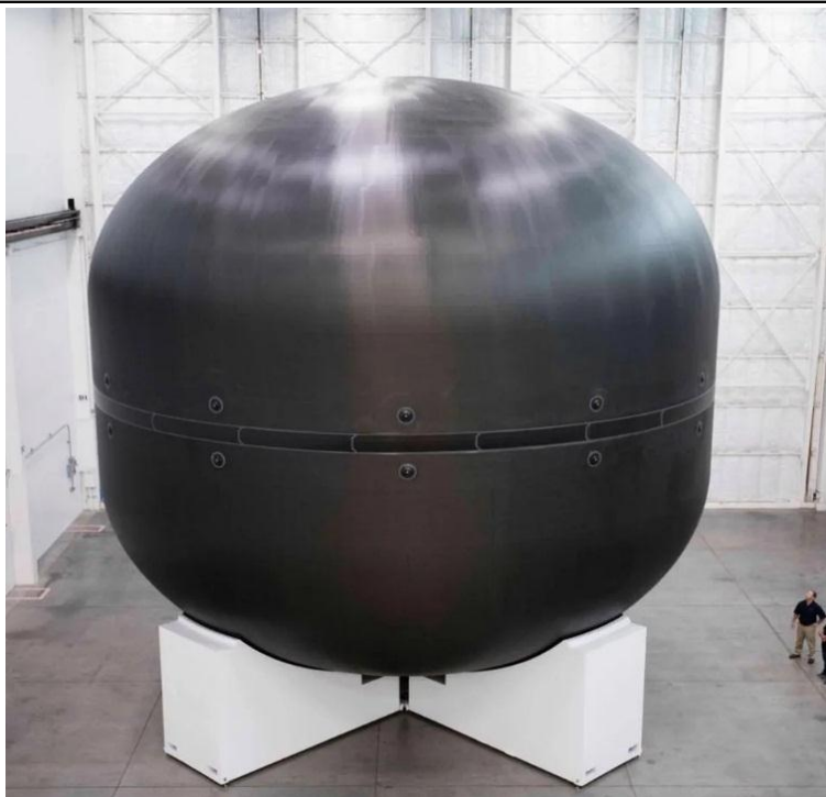
Рисунок 4 – Кріогенний паливний бак із вуглепластику компанії SpaceX
