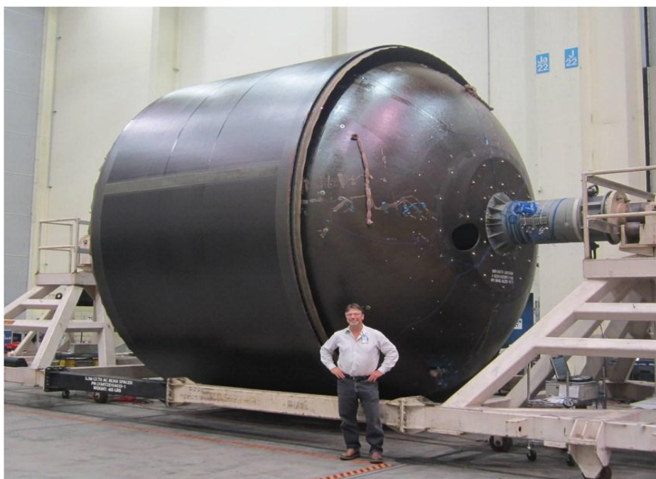
Рисунок 2 – Кріогенний паливний бак компанії Boeing
