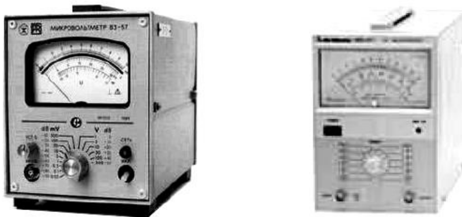
Рисунок 2.19 – Зовнішній вигляд електронних аналогових вольтметрів: а – мікровольтметр ВЗ-57; б – мілівольтметр АВМ-1071
