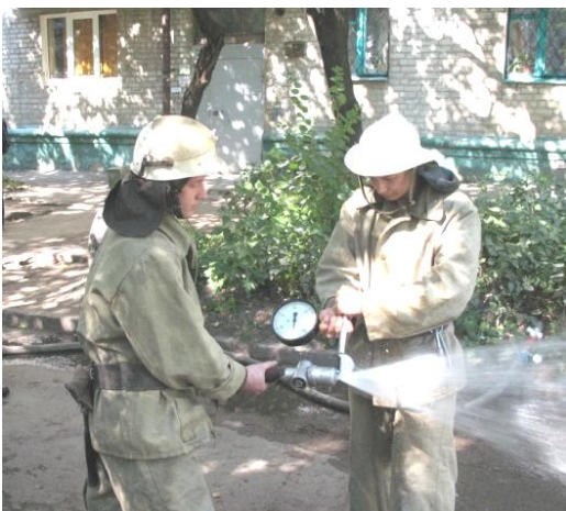
Рисунок 8.4 – Визначення швидкісного тиску за допомогою трубки Піто
