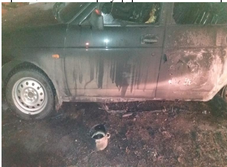
Різні ступені ураження лакофарбового покриття на задніх дверях автомобілю – від відшарування та карбонізації шару фарби (ділянка ближча до передніх дверей) до його повного вигорання (ділянка ближча до заднього колеса).
