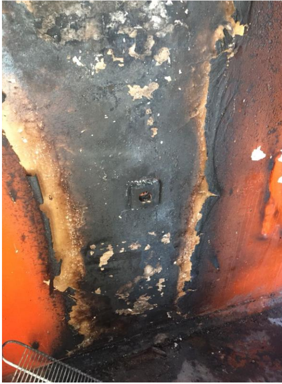
«Осередковий конус», що сформувався шляхом вигорання фарбового покриття на нашаруванням кіптяви.
