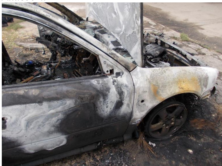
Кольори мінливості та жару на елементах кузову автомобілю.
