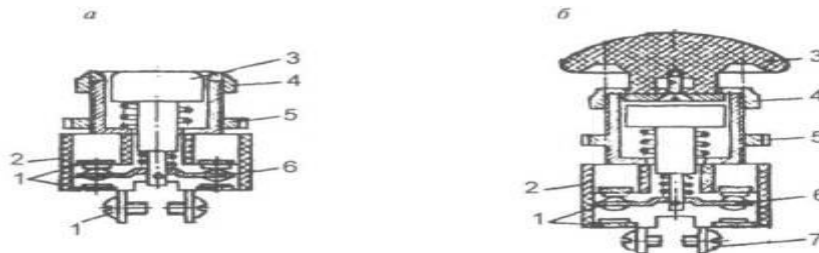
Рис. 1.41. Кнопки керування: а - двухцепна типу КУ2;
