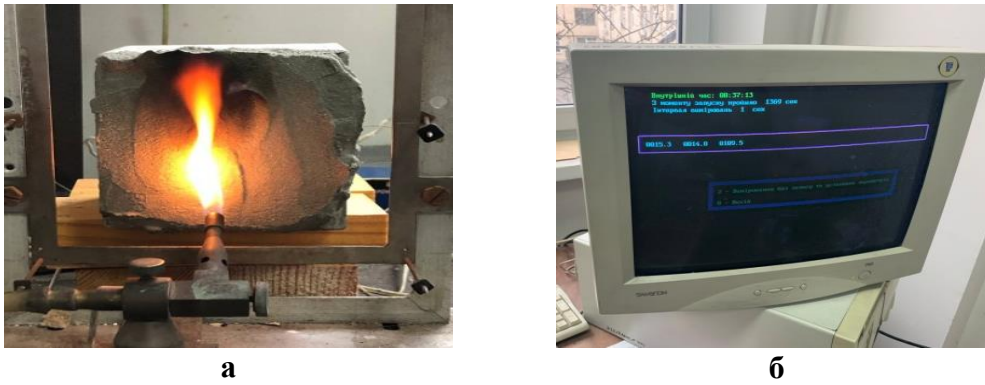
Рис. 1. Визначення теплоізоляційних властивостей вогнезахисного зразка бетону: а – температурний вплив на зразок бетону; б – реєстрація температури.
