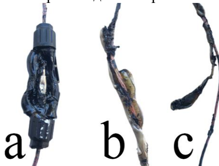
Рис. 3. З'єднувач (а) та провідники (b), (c) після випробування.
