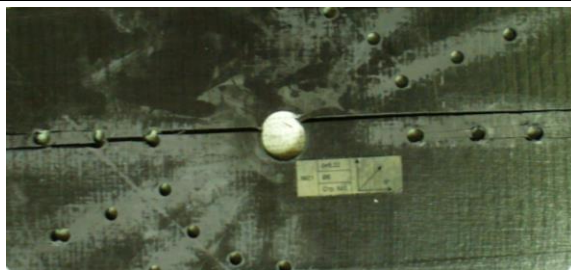
Рис. 1. Зразок зі структурою [0^\circ_{0.8}; \pm 45^\circ_{0.2}] зі слідами руйнування на зріз.
