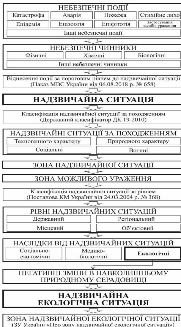
Рис. 1. Модельне подання процесів виникнення надзвичайних екологічних ситуацій в умовах впливу небезпечних чинників надзвичайних ситуацій природного, техногенного, соціального та воєнного характеру.
