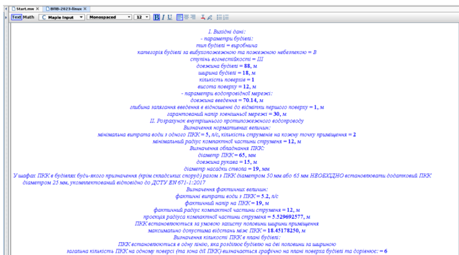
Рис. 1. Результат розрахунку ВПВ одноповерхової складської частини будівлі виробничого об'єкта за допомогою програмного комплексу «ВПВ-2023».
