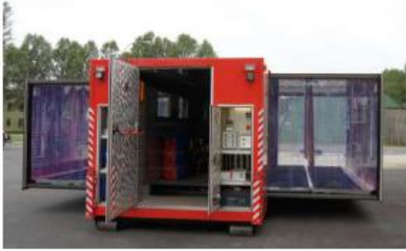
Рис. 3.7. Модуль для виконання рятувальних робіт в умовах радіаційного та хімічного забруднення
