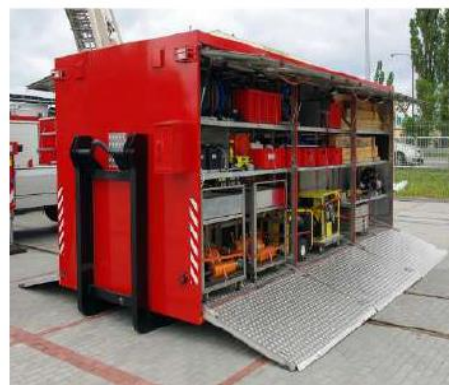
Рис. 3.4. Модуль для виконання робіт з пошуку та рятування людей в зруйнованих будівлях
