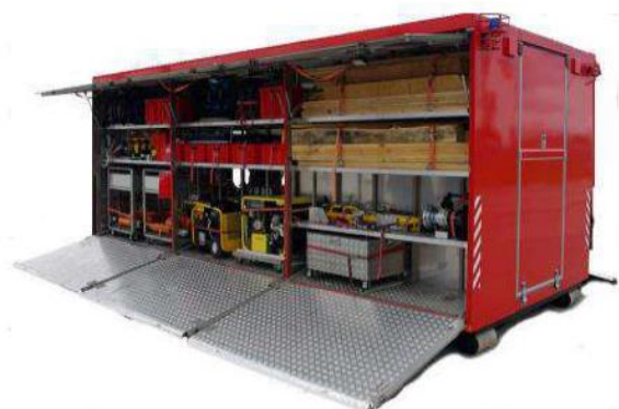
Рис. 3.4. Модуль для виконання робіт з пошуку та рятування людей в зруйнованих будівлях
