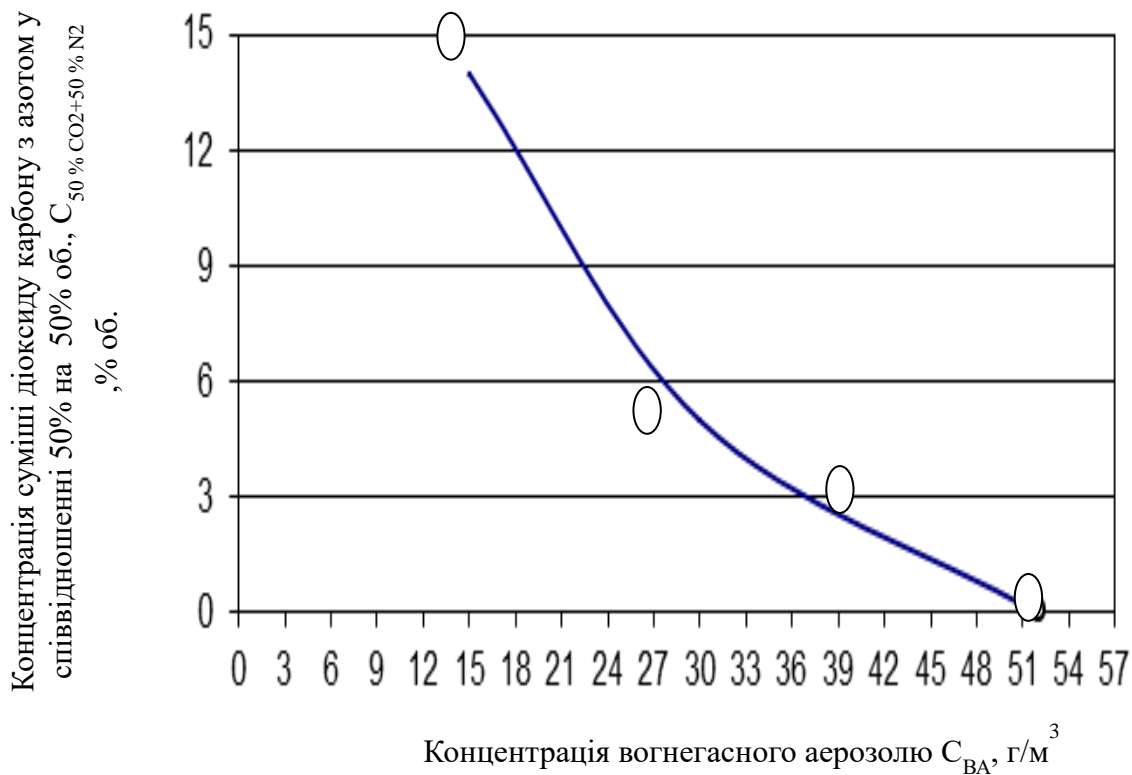
Рисунок 3.2 - Графік залежності змінення флегматизувальної концентрації гексаноповітряного горючого середовища від співвідношення вмісту вогнегасного аерозолу, згенерованого з АУС БАГР, та суміші діоксиду карбону з азотом у співвідношенні 50% на 50% об. за сумісного комбінованого їх подавання у випробувальну камеру (за результатами експериментальних даних)
