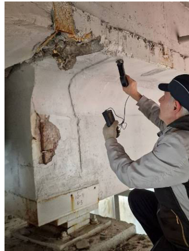
Рис. 2. Руйнування балок; визначення міцності бетону
