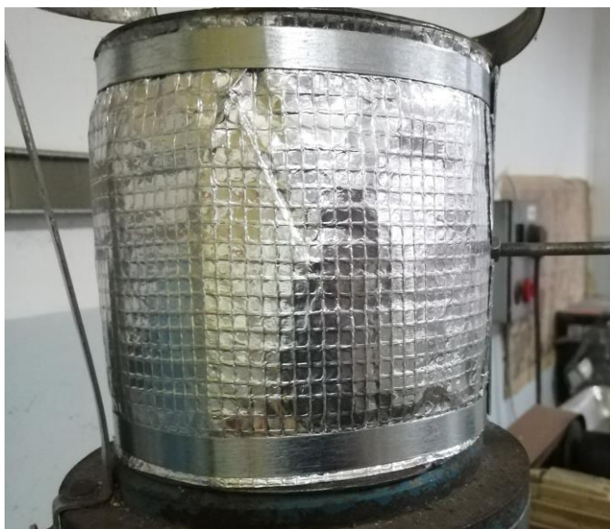
Рис. 2. Загальне фото спеціальної камери для сушіння лісорослинницьких відходів із функцією перевертання на 180°
