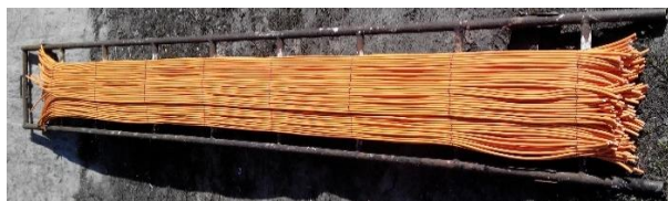
Рисунок 4 – Вигляд кабелів у спеціальній рамі для формування пучка категорії А за [7].
