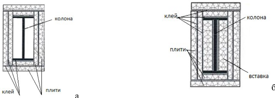
Рисунок 2 – Схема перерізу зразків у відповідності до схеми вогнезахисту. а – переріз зразків № 1, 2, 5, 6; б – переріз зразків № 3, 4, 7, 8
