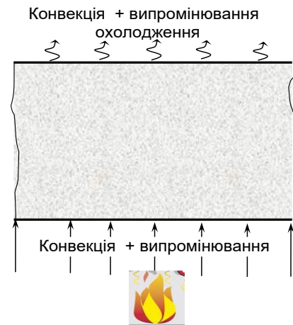
Рисунок 4 – Розрахункова схема до теплового розрахунку огорожувальних конструкцій кабельного тунелю
