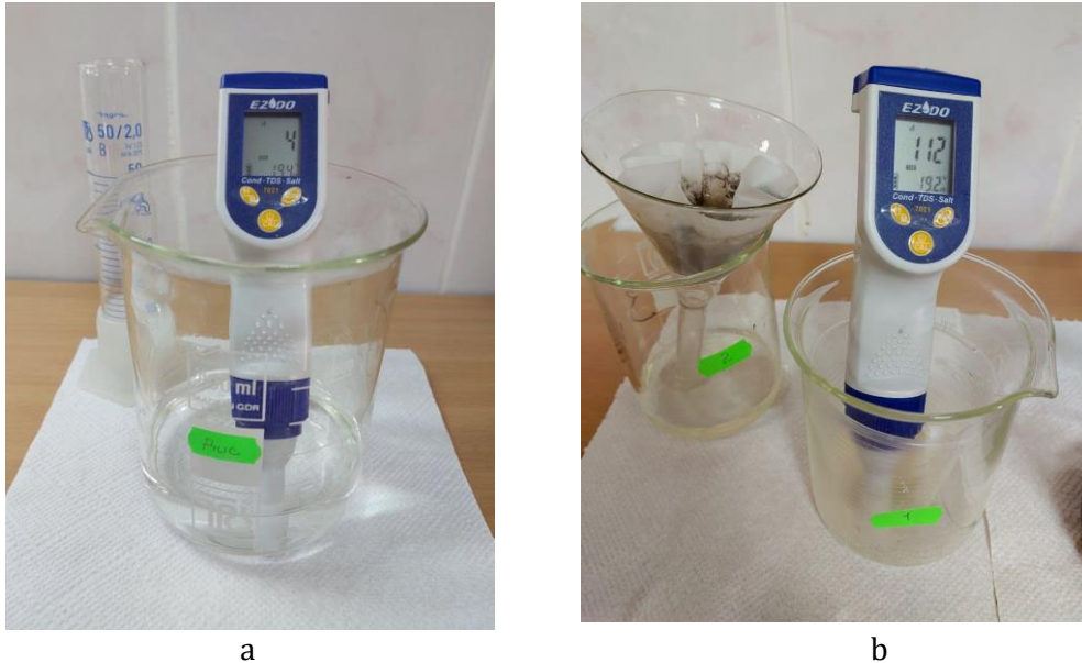
Рис. 1. Практичне застосування методу кондуктометрії: а) вимірювання електропровідності дистилляту; б) вимірювання електропровідності водної витяжки проби ґрунту з забрудненої території
