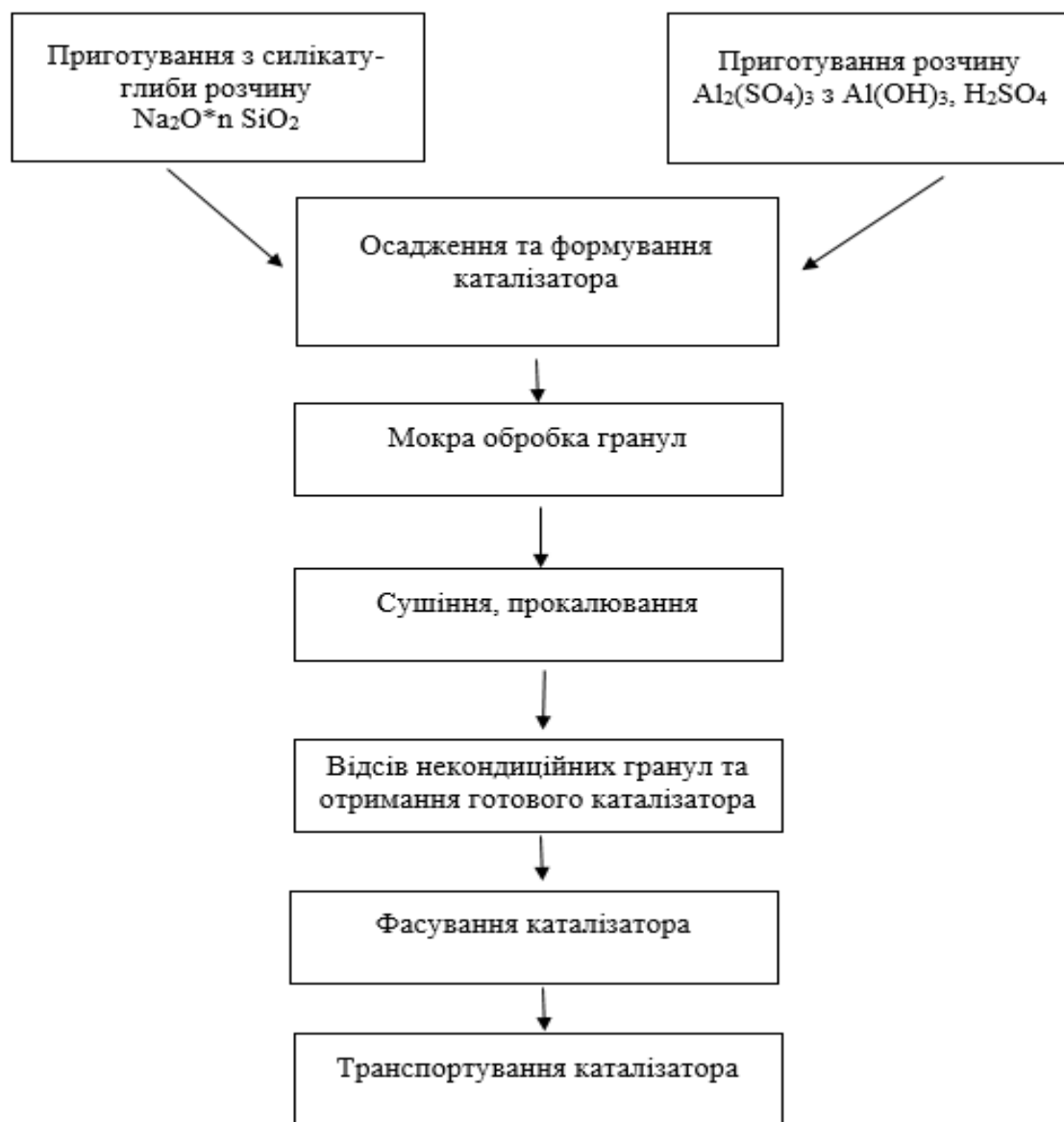
Рисунок 1 – Принципова технологічна схема отримання мікросферичного алюмосилікатного каталізатора.
