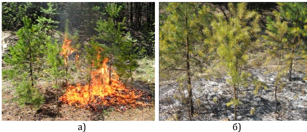
Рисунок 2 – Фото процесу розповсюдження горіння ділянкою соснових молодняків на 62-ій с від початку підпалу з переходом низової пожежі у верхову (а) та наслідків верхової пожежі соснових молодняків тривалістю 93 с (б)
