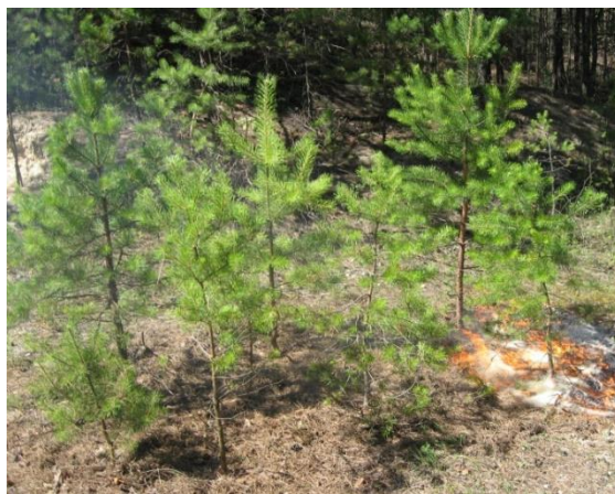
Рисунок 1 – Фото процесу розповсюдження експериментальної пожежі на штучно сформованій ділянці соснових насаджень віком до 10 років на 20-ій с від початку її підпалу
