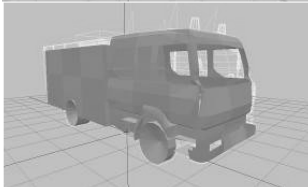
Ryc. 10. Model P3D widoku kabiny załogi oraz model kolizji samochodu pożarniczego Fig. 10. P3D model of the crew cabin view and fire-fighting vehicle collision model
