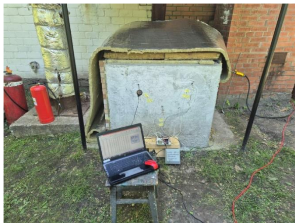
Рисунок 2 – Вигляд малогабаритної вогневої печі перед початком випробування
