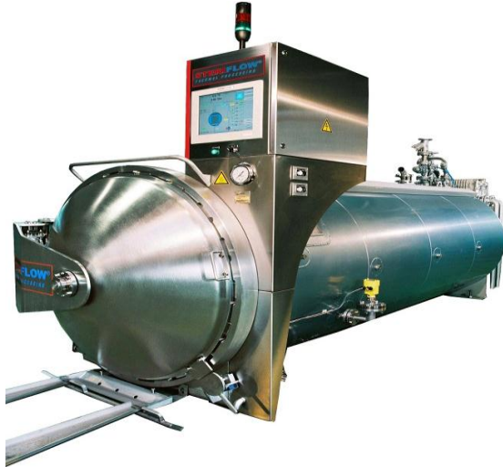
Рис. 2.7. Установка для глибокого просочення деревини
