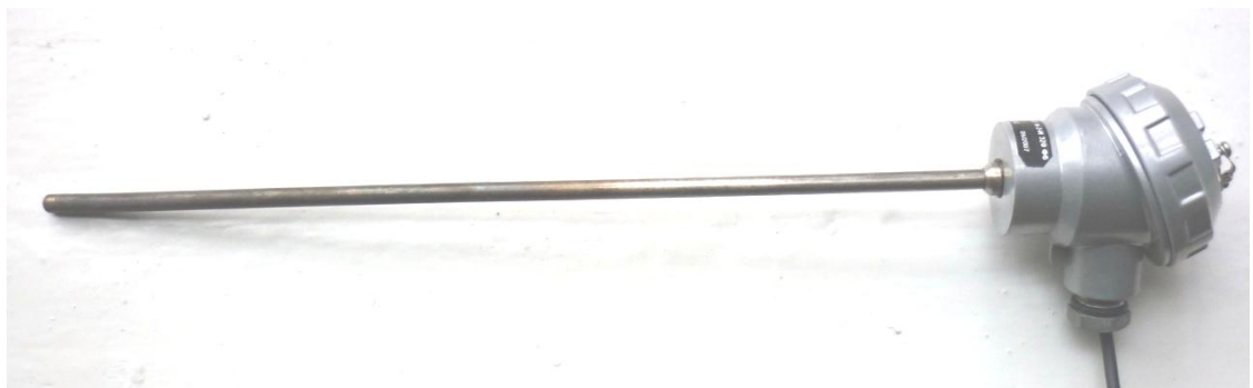
Рис. 2.4. Термопара ТХА 1-27-К-2-И-320-INC-6-А
