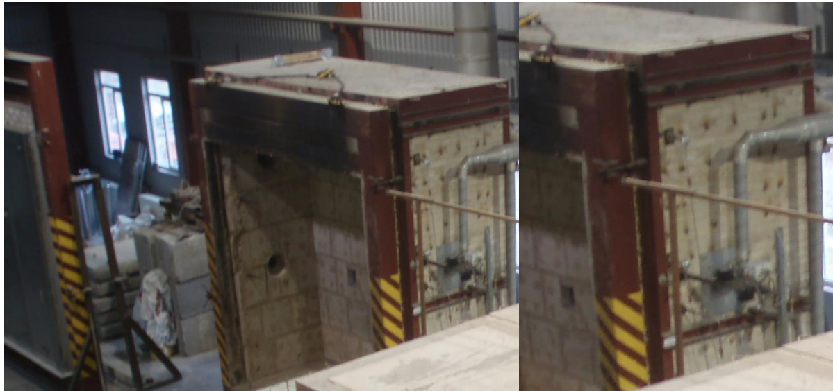
Рис. 3.1 – Загальний вигляд установки для випробувань: а – загальний; б – форсункова система
