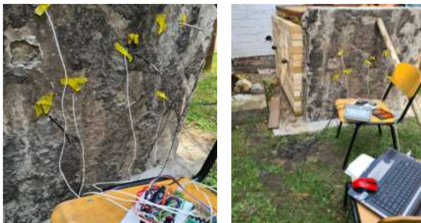
Рисунок 3.13. Вигляд заздалегідь виготовленого фрагмента несучої залізобетонної стіни для виконання випробування зі встановленими датчиками контролю температури
