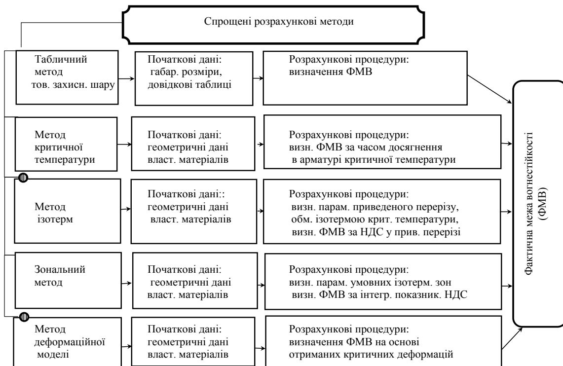
Рисунок 1.11. Структурна схема спрощених розрахункових методів визначення вогнестійкості будівельних конструкцій
