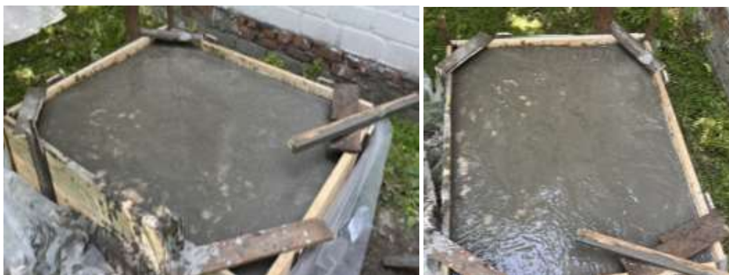
Рисунок 3.11. Фото виготовлення фрагментів несучих залізобетонних стін для виконання дослідження з їхнього нагрівання
