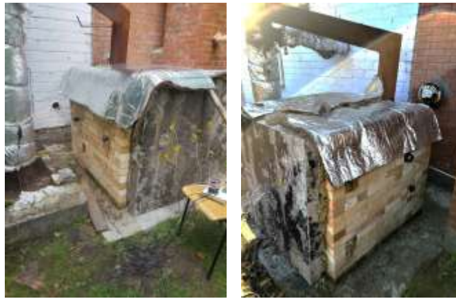
Рисунок 3.15. Розташування засобів вимірювальної техніки під час виконання експерименту з нагрівання несучої залізобетонної стіни: а – ліва сторона п-подібної камери вогневої печі, б – права сторона, де розташована одна термопара
