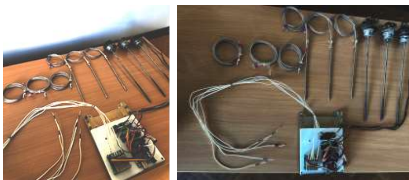
Рисунок 3.9. Спеціальний засіб зчитування інформації – блок комбінованого обчислення температур
