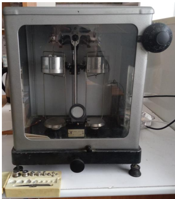
Рисунок 6 – Ваги лабораторні ВЛА-200г-М, що використовувались для зважування зразків.
