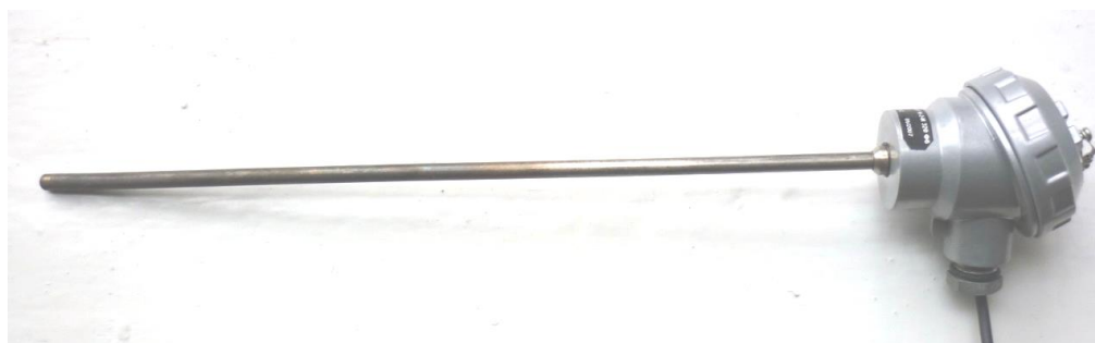
Рисунок 4 – Термопара ТХА-VIII – 1-27-К-2-И-320-INC-6-А-(0...1100)°С.
