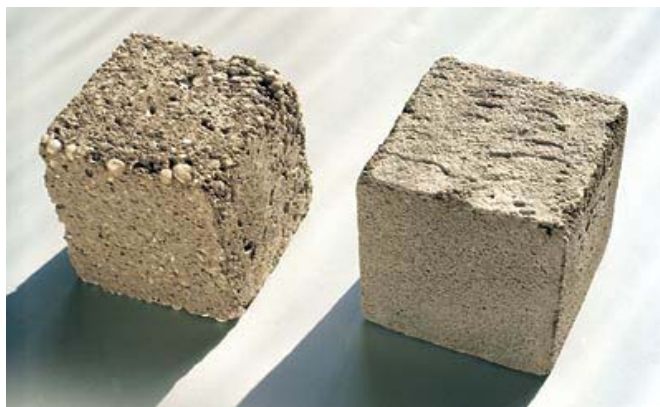
Рис. 1 – Ступінь розміцнення бетону до 800 °С та понад 1000 °С
