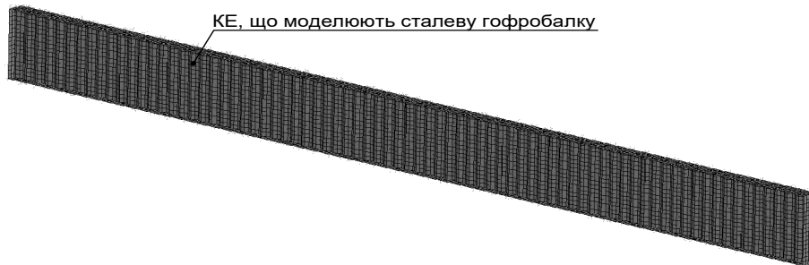
Рис. 1. Кінцево-елементна схема сталеві гофробалки
