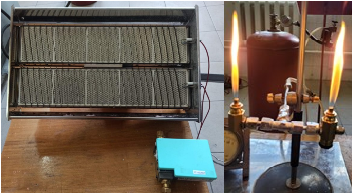
Рисунок 4 – Загальний вигляд доопрацьованої радіаційної панелі та блока газової автоматики і робочий момент досліджень витратних характеристик двох її форсунок
