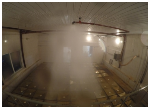
Рисунок 9 – Загальний вид форми розпилювання води зі зрошувача за вертикальної його орієнтації у просторі та робочого тиску 8 бар: а) – вид спереду; б) – вид збоку
