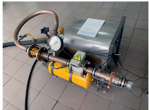
Fig. 2. Pumping unit (photo Oleh Zemlianskyi).
