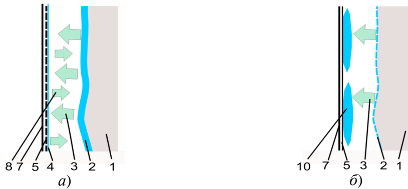
Рис. 1 - Динаміка вологи, що виділяється із потом при використанні одягу з гідрофобної оболонки: а – без використання додаткових елементів; б – з поглинаючими вологу вставками: 1- тіло; 2 – виділення поту на шкірі; 3 – потік вологи від тіла; 4 – конденсат на тканині; 5 – вологопрониклива тканина; 6 – потік вологи, що випаровується зовні; 7 – непрониклива оболонка; 8 - потік пари від конденсату, що випарувався; 9 - охолоджуючий елемент; 10 – вставка для поглинання вологи
