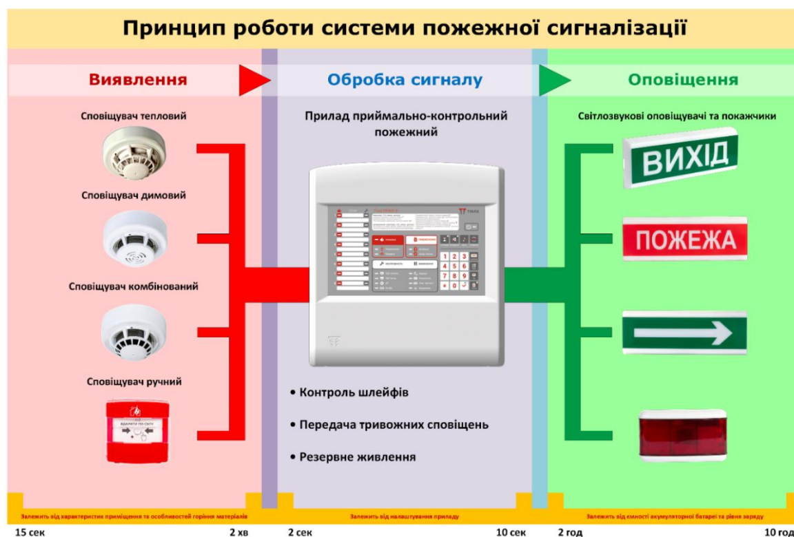
Рис. 2.1. Принцип роботи СПС
