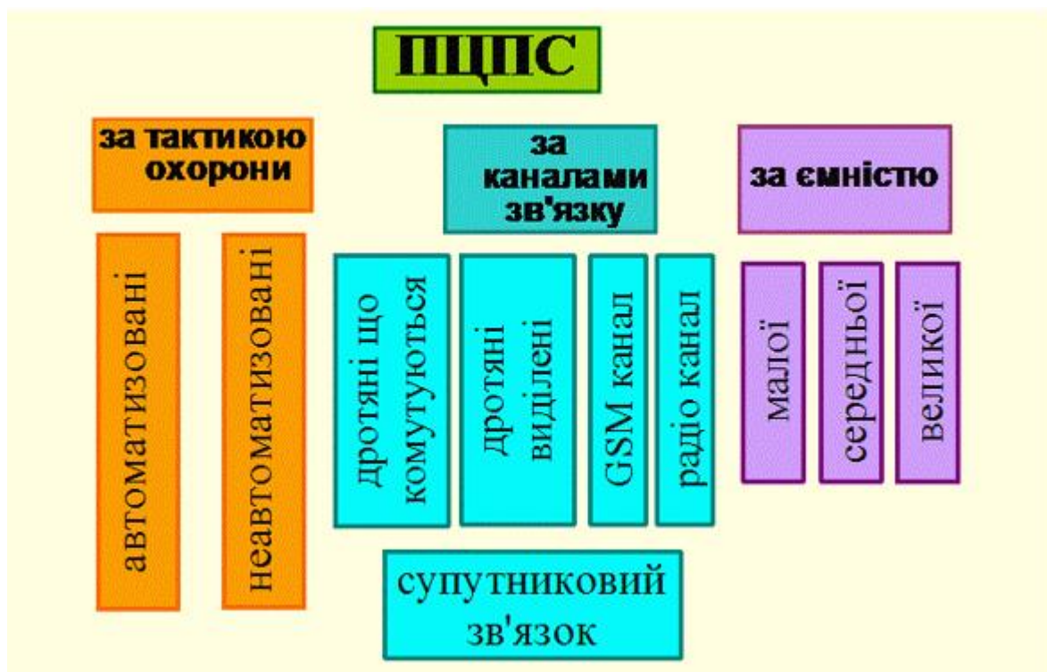
Рис.5.1.2. Класифікація пультів централізованого пожежного спостереження
