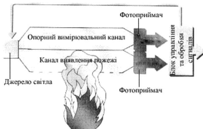
Рис 2.3.2.9. Загальний принцип роботи ПС ESD530
