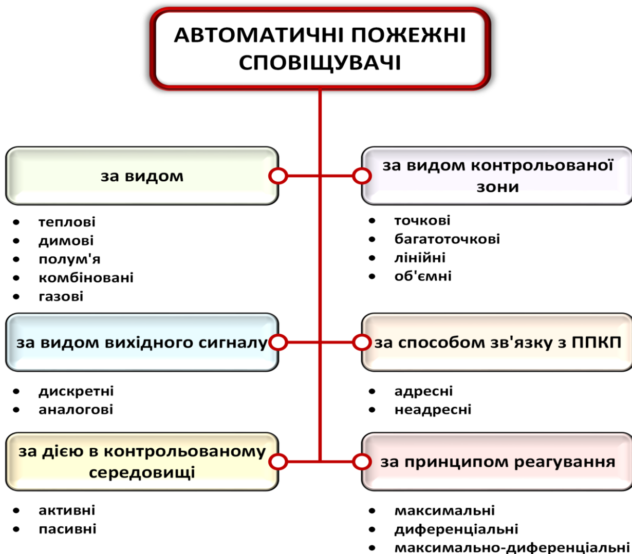
Рис. 2.1.1.1 Класифікація автоматичних пожежних сповіщувачів
