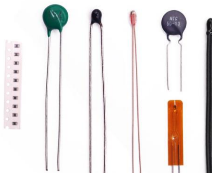
Рис. 2.2.3.1. Приклад терморезисторів різних типів
