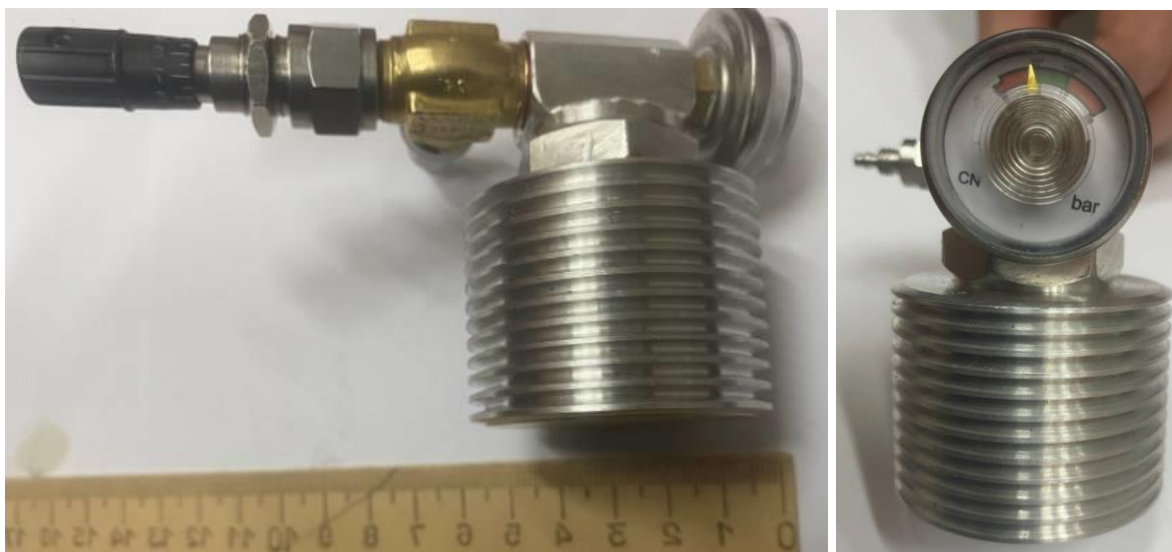
Рисунок 1. Устройство хранения водорода изготовлено из дюралюминия, что делает его сверхлегким.
