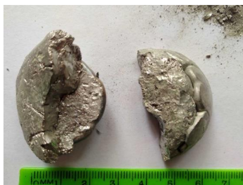
Рис. 3. Сплав носителя гидрида водорода, выплавляемый в виде слитков
