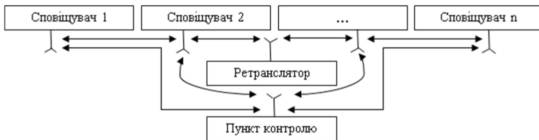
Рис. 1 – Спрощена хема вдосконаленої системи пожежно-охоронної сигналізації
