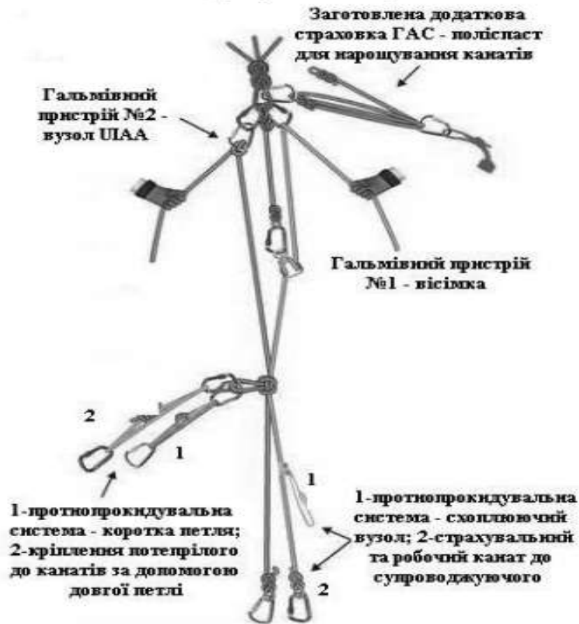
Рису. 1 – Кріплення потерпілого та супроводжувача до спускових канатів та приклади організації протипрокидувальних систем
