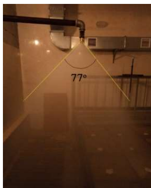
Рисунок 4 – Кут розкриття форсунки
