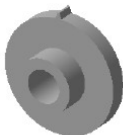
Рисунок 7 – Проміжна модель зубчастого колеса
