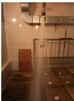
Рисунок 6 – Кут розкриття форсунки
