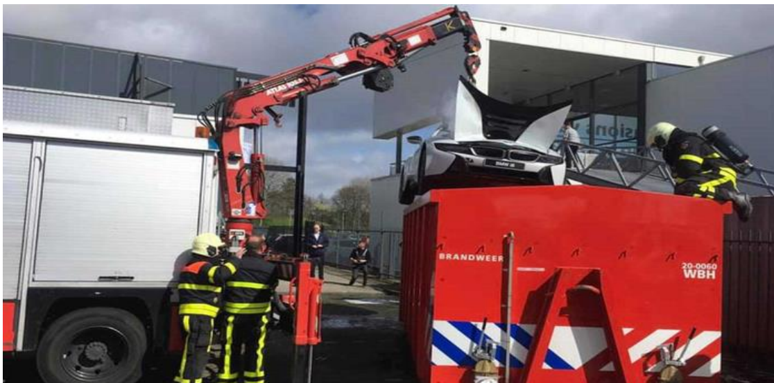
Рис. 1 – Пожежний автомобіль – контейнер для гасіння пожеж на електроавтомобілях, для повного занурення автомобіля за допомогою маніпулятора
