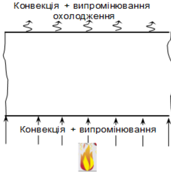
Рис. 1 – Розрахункова схема до теплового розрахунку залізобетонних плит
