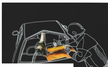
Встановити розтискач по середині, між задньою полицею і дахом автомобіля;
