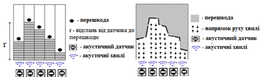
Рисунок 2 – Графічне представлення роботи пристрою акустичної дії
