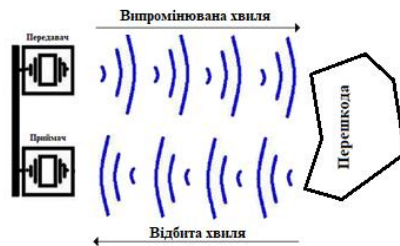
Рисунок 1 – Принцип роботи пристрою акустичної дії
