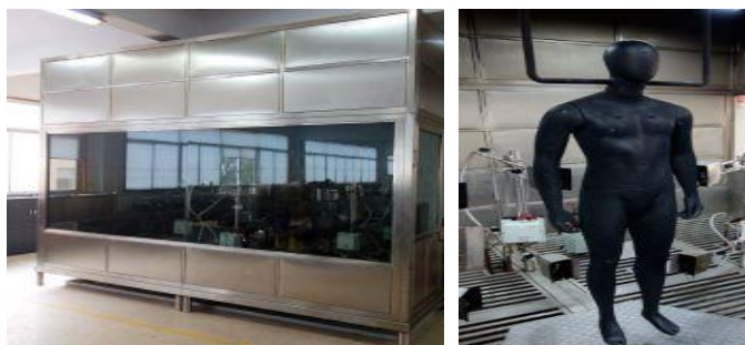
Фото 1 – Основні елементи випробувального устаткування для проведення натурних вогневих випробувань захисного спорядження пожежника
